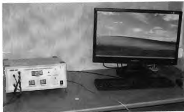
Рис. 19. Фотография лазерного анализатора капиллярного кровотока ЛАКК-02 для исследования параметров микроциркуляции крови
